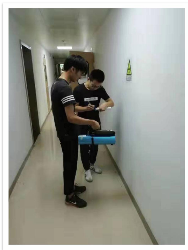
图 13 老师带领学员在本单位 C 楼一层的源库对周围环境辐射水平进行监测。
